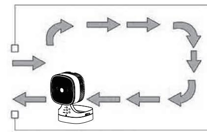
※外気を取り込んだり、部屋の空気を排出させる
