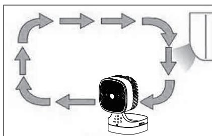
※床の冷気を循環させる
