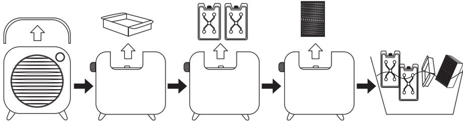
①給水フタを外す。②計量カップを外す。③保冷剤を外す。④フィルターを外す。⑤水洗いをする。
