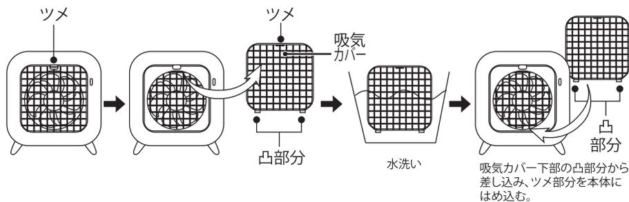
吸気カバー下部の凸部分から差し込み、ツメ部分を本体にはめ込む。
