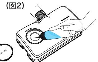
●ウォーターモップ本体上面の給水フタを取り外し、給水口を手で押さえながらウォーターモップ本体を逆さにして水を抜いてください。また、付属のスポットを給水口に挿して吸い取りながら水を抜くことも可能です。
