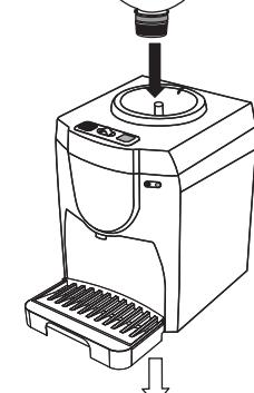
※飲料水ボトルを両手で持ち上げ逆さにして、ボトル差込口の中央に合わせてセットしてください。
