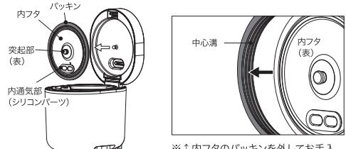
※↑内フタのバッキンを外してお手入れした後は、再度バッキンを内フタにはめ込む際に、上記のようにバッキンの中心溝に内フタをセットしてください。
