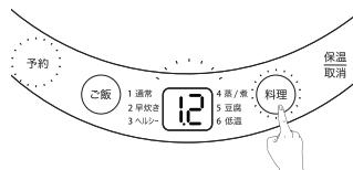
※調理時間選択時、ヘルシーモード、蒸/煮モードは60分、低温モードは90分が標準設定になっており、何も選択しない場合、標準設定時間(蒸/煮モードは60分、低温モードは90分)のまま設定が完了し、予約が自動で開始します。
