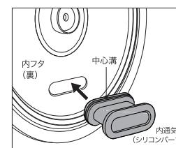
※←内通気部(シリコンパーツ)を外してお手入れした後は、再度シリコンパーツを内フタにはめ込む際に、シリコンパーツの中心溝に内フタをセットしてください。
